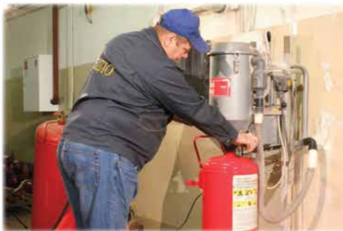
Станция зарядки порошковых огнетушителей. На фото: Василий Андреевич Мингалев – зарядчик порошковых и углекислотных огнетушителей
